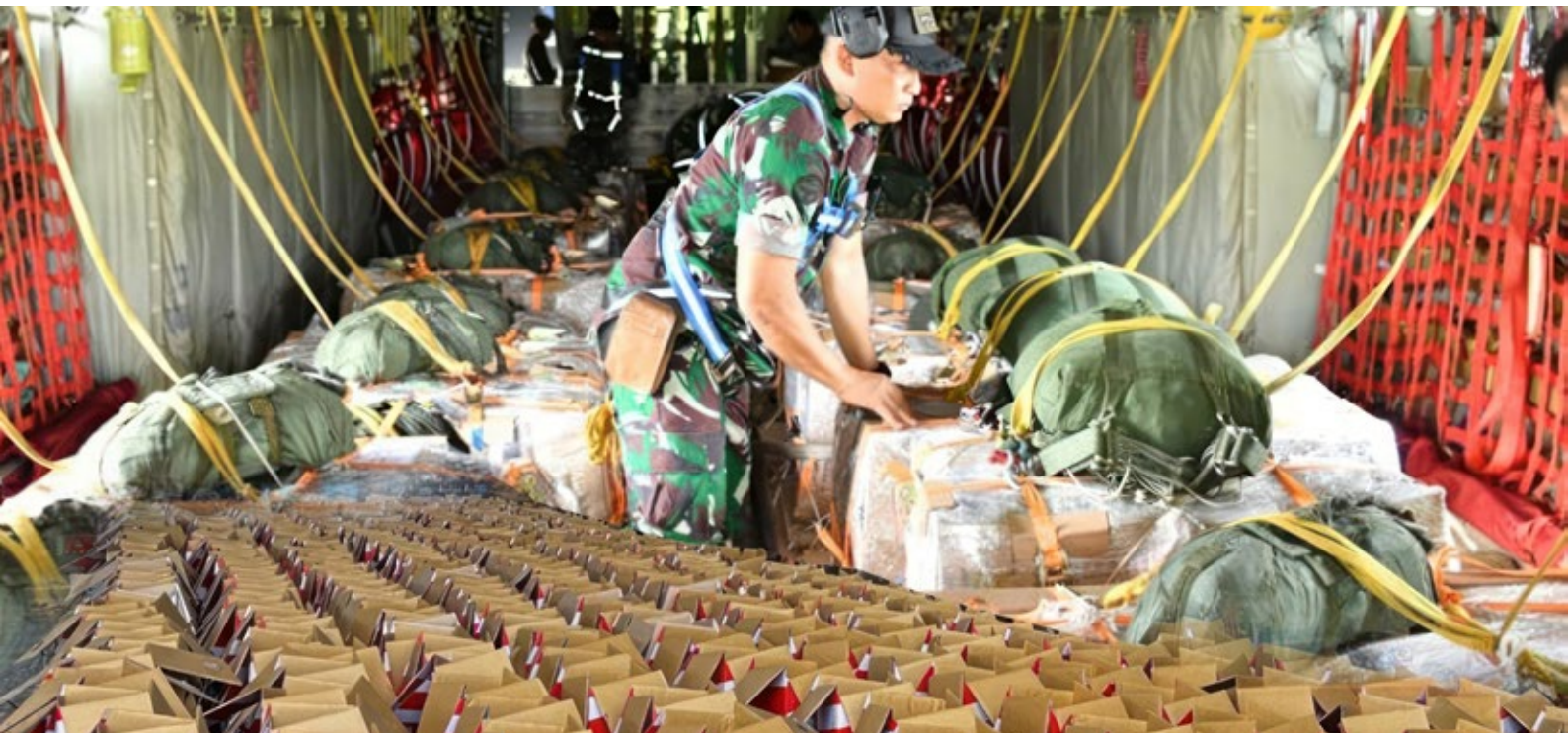
Keterangan Gambar : Persiapan pengedropan barang bantuan dengan LCLA (Low Cost Low Altitude) dan hellybox.
